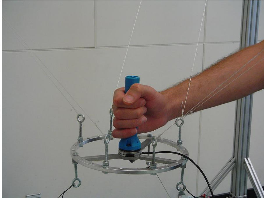
FIG. 6.7 – Photo de la plate-forme munie du capteur d'efforts.
