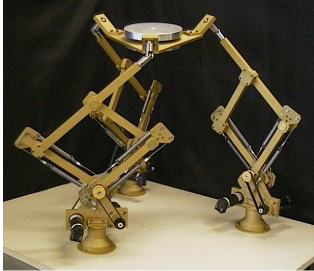
Fig. 1.7: Manipulateur parallèle à 3 pattes possédant 6 degrés de liberté équilibré statiquement. Ce prototype a été développé au Laboratoire de robotique de l'Université Laval.
