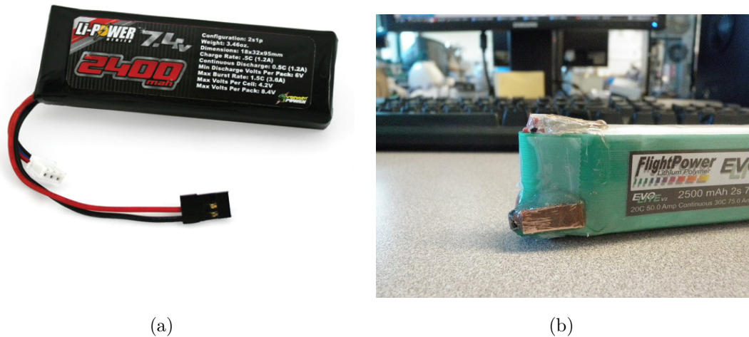
FIGURE 3.8 – a- Batterie LiPo avec connecteurs originaux, b- Batterie avec connecteurs modifiés
