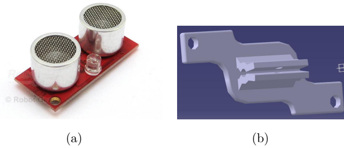
FIGURE 4.2 – a- Modèle SRF08, b- Nouveau modèle d'attache en SLS
