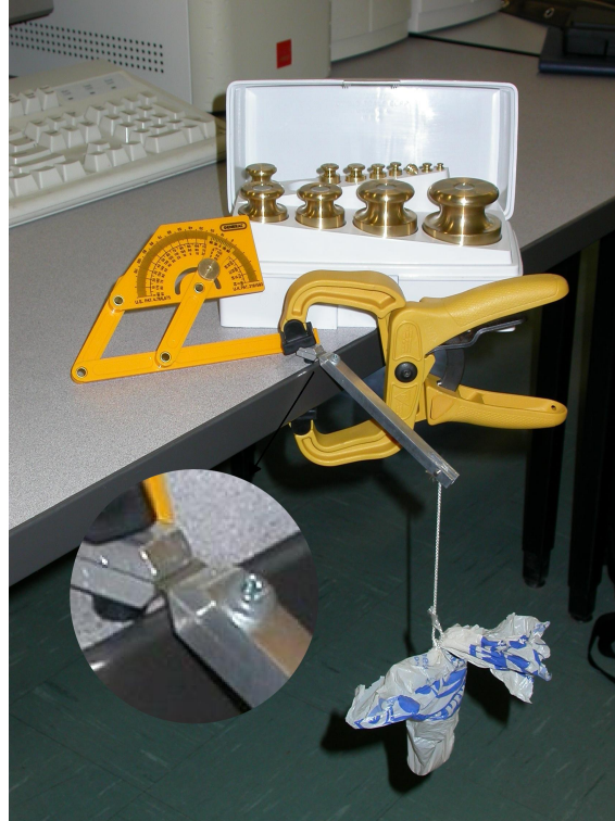
FIG. 3.7 – Montage pour tester les articulations en nitinol.
