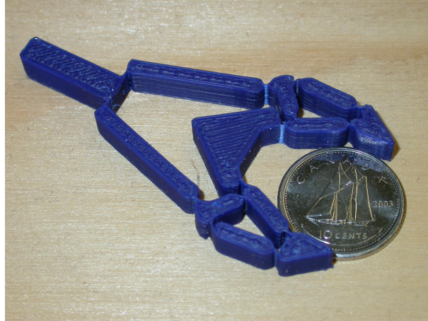
FIG. 6.3 – Main plane à deux (2) phalanges fabriquée en prototypage rapide de type FDM.
