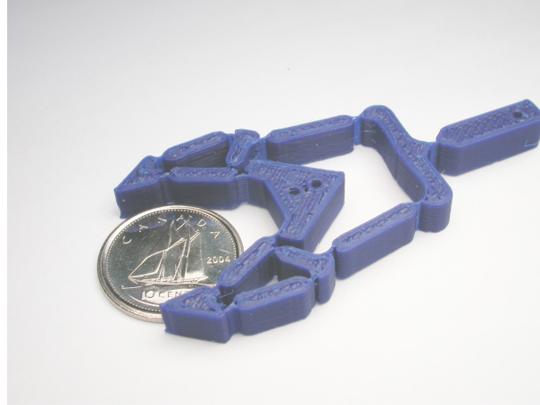
FIG. 6.11 – Main plane à deux (2) phalanges avec un sous-actionnement à bascule.
