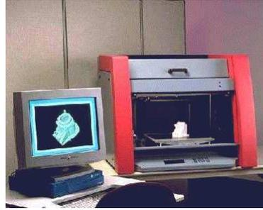
Figure 5.10: La machine à prototypage rapide.
