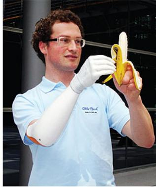
FIGURE 2.12 – Épeluchage d’une banane avec la main MichelAngelo (source : Otto Bock).
