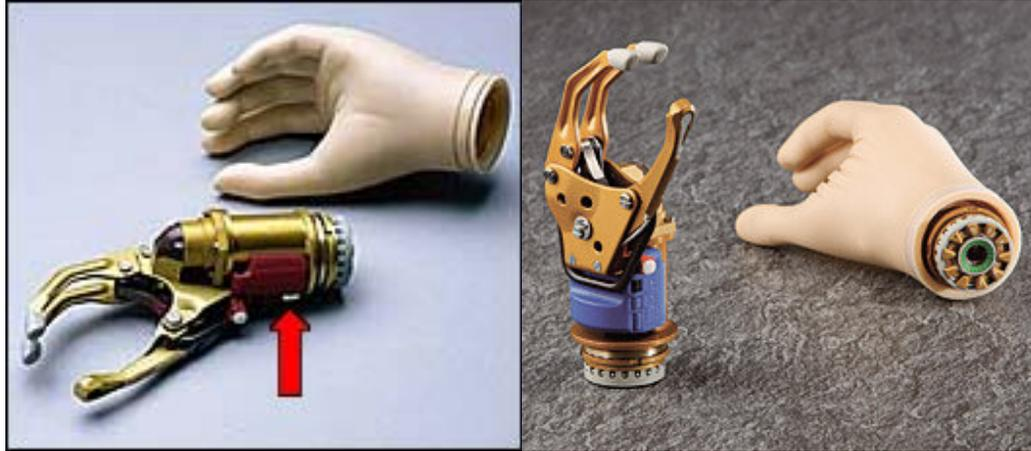
FIGURE 2.10 – La Sensor Hand d’Otto Bock avec et sans gant cosmétique (source : Otto Bock).
