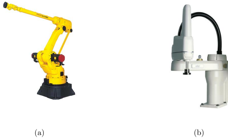
FIG. 2.1 – Robots sériels : (a) robot à six degrés de liberté FANUC S-500iB [5] et (b) robot SCARA Adept Cobra 600 [6].
