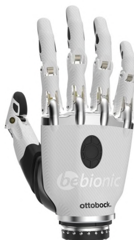
(b) Prothèse bebionic tiré de (ottobock, 2017a)
