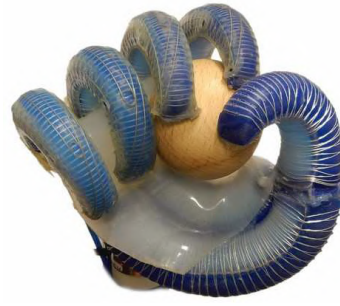
(b) articulation complètement molle tirée de Wall et al. (2017)
