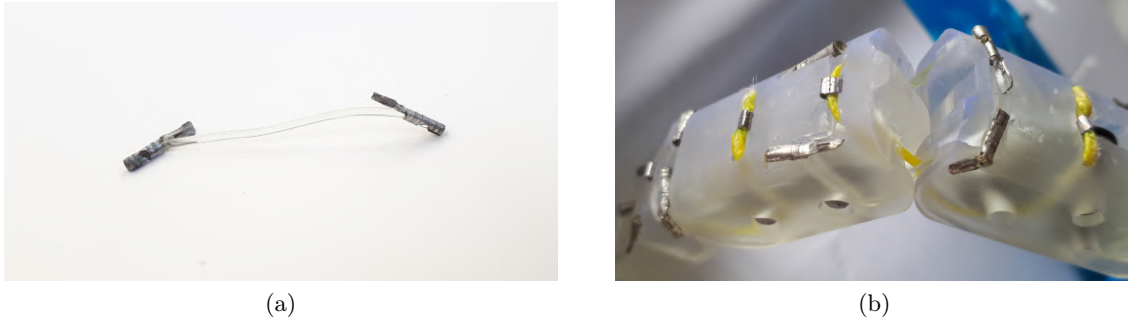
FIGURE 2.10 – (a) Câble élastique avant son insertion dans l'articulation et (b) vu d'ensemble d'une articulation. Le câble rigide est en jaune pour une meilleure visualisation.
