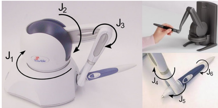
FIGURE 1.4 – Manipulateur haptique Geomagic Touch populaire sur le marché, de la compagnie Geomagic. Il s'agit d'un manipulateur sériel à 6 DDL à l'espace de travail de 160x120x70 mm [Coles et al., 2011], servant entre autres à la modélisation d'objets tridimensionnels grâce à l'interaction haptique en un point par l'extrémité du « stylet ».
