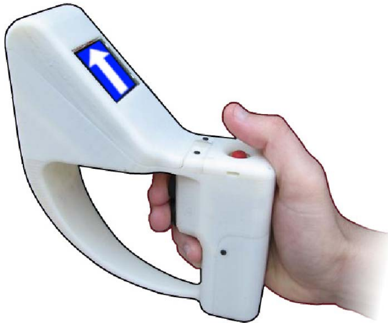
FIGURE 1.6 – Appareil de navigation utilisant un tacteur se déplaçant sur la surface du pouce pour transmettre des messages cutanés, tiré de Koslover et al. [2012].
