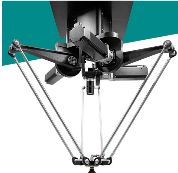
FIGURE 1.12 – Exemple de robot Delta : le SIAX D3 500 de SIPRO. (Source de la photo : www.sipro.vr.it/en/delta-robot/delta-robot-SIAX-D3-500.html , consulté le 08/04/19)
