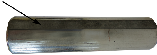
FIGURE 3.15 – Photographie du plat usiné sur un aimant du second prototype .
