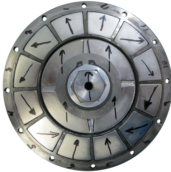
FIGURE 3.27 – Intérieur du troisième prototype, une fois assemblé.
