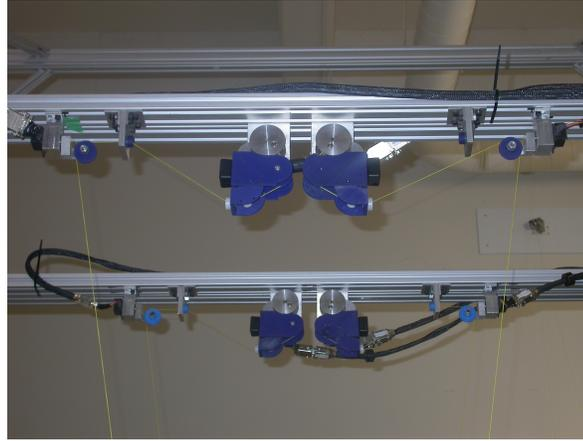
FIGURE 5.4 – Photo de l'arrangement des enrouleurs simples.
