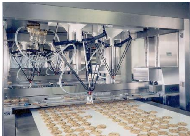
FIG. 3.1 – Le mécanisme parallèle à 3ddl DELTA.
