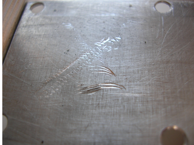
Figure 5.10 : Problème de coincement des vis de pression désassemblées.
