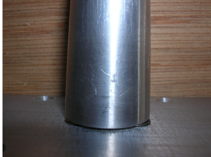
Figure 5.15 : Problème de précision d'usinage des arbres centraux.
