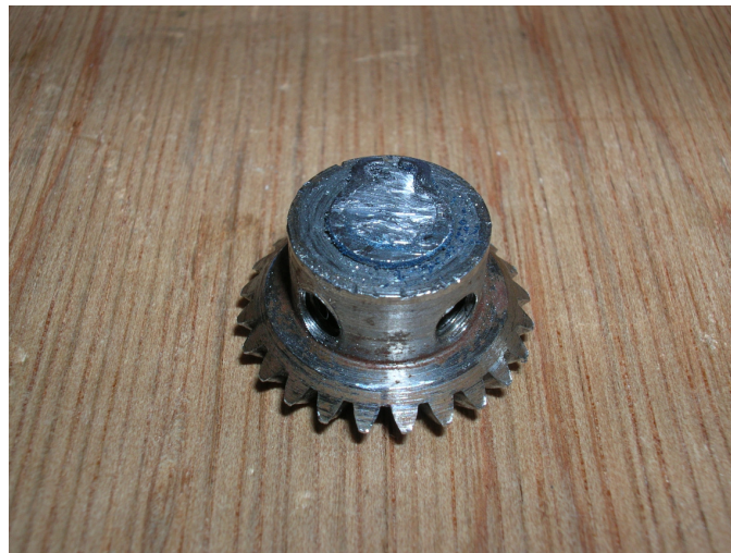
Figure 5.12 : Problème de désassemblage des arbres centraux.
