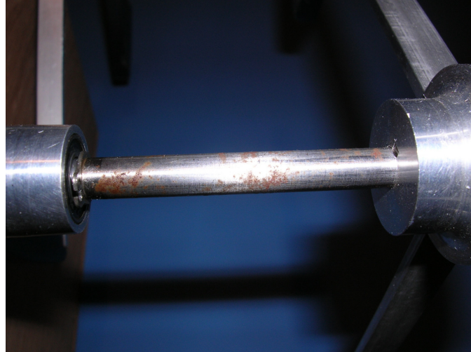
Figure 5.8 : Problème de corrosion des arbres.
