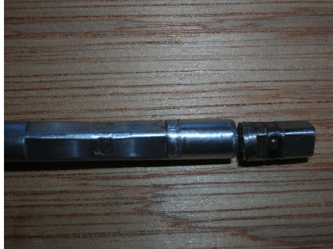
Figure 5.13 : Problème d'alignement des vis de pression des arbres centraux.
