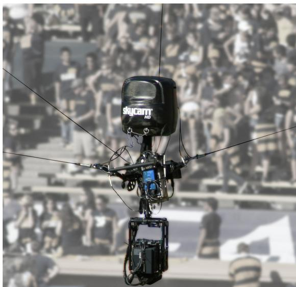
FIG. 2 – Le Skycam, une caméra robotisée entraînée à l'aide de câbles.
