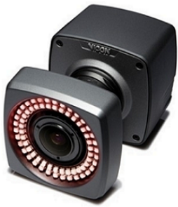
(a) Caméra Vicon 2 pour la capture de mouvement avec des marqueurs passifs.
