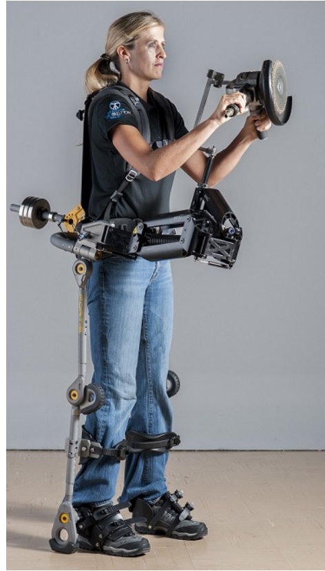
(b) L'exo-squelette passif pour la maintenance développée chez Lockheed Martin 5 réduit le poids apparent des outils et par conséquent la fatigue liée à leur manipulation.
