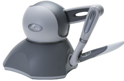
FIGURE 4: PhantomOmni 6 : une interface haptique à 6 degrés de liberté (MASSIE et SALISBURY, 1994).
