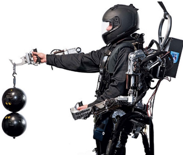
(b) L'exo-squelette motorisé développé par la Darpa 3 possède une batterie à l'arrière du dos fournissant l'énergie aux actionneurs. Une charge peut être portée à bout de bras sans effort de la part de l'utilisateur.
