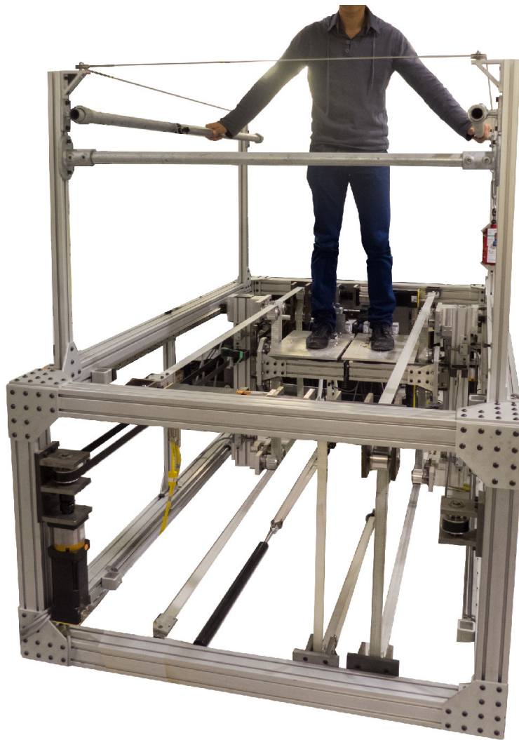
FIGURE 5.2: Mise en place de l'utilisateur sur l'interface de locomotion pour la navigation en environnement virtuel.
