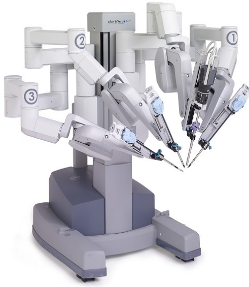
FIGURE 1: Le robot DaVinci 1 , de Intuitive Surgical, est un appareil utilisé pour la téléopération chirurgicale. Un modèle maître est manipulé par le chirurgien tandis que le modèle esclave interagit avec le patient.
