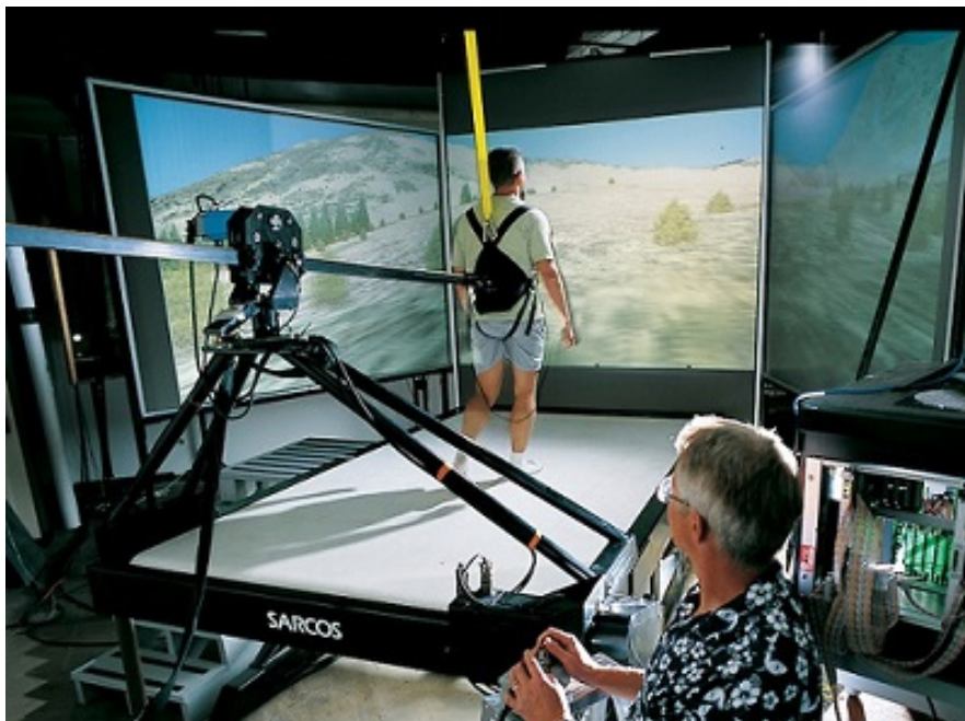
(b) Sarcos Treadport : un tapis de course équipé d'un harnais actif pour la simulation d'environnement en pente ou en escalier (HOLLERBACH et al., 1999).
