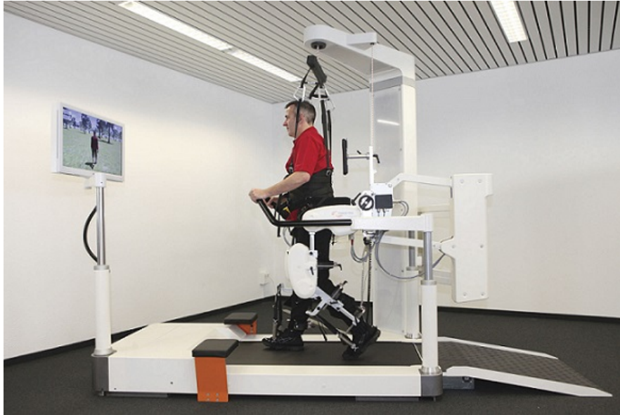
(a) Lokomat 7 : une interface de locomotion développée par la société Hocoma pour la réadaptation de la marche basée sur un tapis de course.
