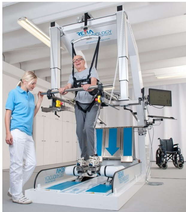
(b) Le G-EO System 8 , développé par la société Reha Technology, est un mécanisme basé sur deux effecteurs pour la simulation de la marche et du mouvement d'escalier.
