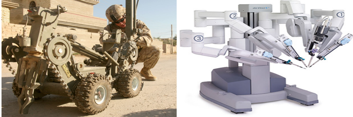
FIGURE 0.1 – Deux exemples de systèmes de télé-opération : à gauche le robot détonateur et à droite le robot médical Da Vinci.
