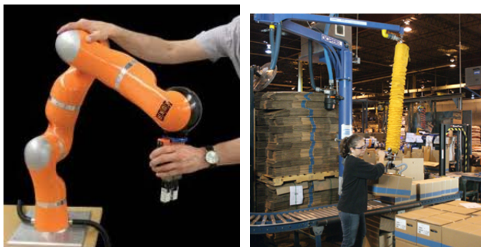
(a) Robot sériel à 7 degrés de liberté LWR de Kuka. (b) Exemple de système mains sur la charge.
