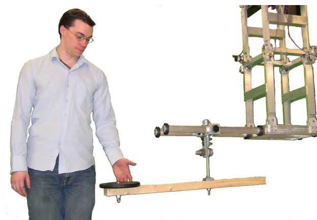
FIG. 4.4 – Décalage du centre de masse avec le mécanisme articulé.
