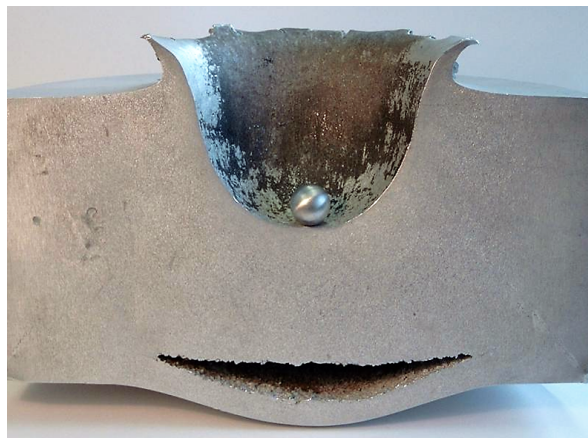
FIGURE 4.5 – Illustration de l'effet d'une collision entre un bloc solide d'aluminium représentant l'engin spatial et un petit débris provenant de tests effectués par ESA 6 .
