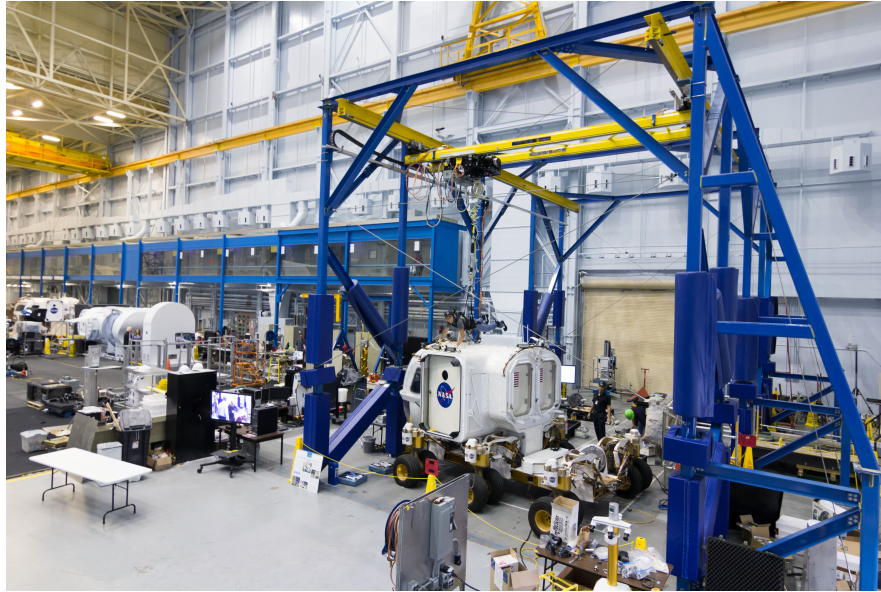
FIGURE 1.13 – Plateforme de compensation de la gravité au Centre d’ingénierie spatiale Johnson 7 .
