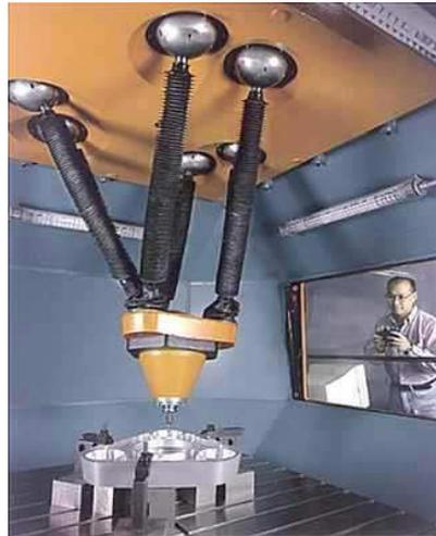
FIG. 2.43 – Protection des vis à billes par un soufflet
