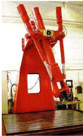
(a) Mécanisme du Tricept
