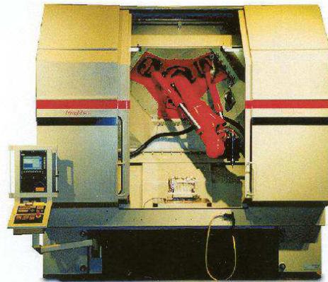
(b) Centre d'Usinage 5 axes
