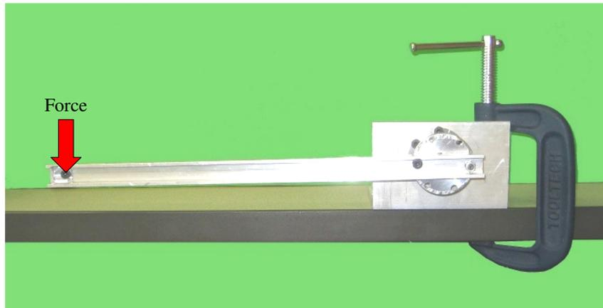
FIG. 6.6 – Montage expérimental permettant d'étalonner le limiteur de couple à l'aide d'un dynamomètre.
