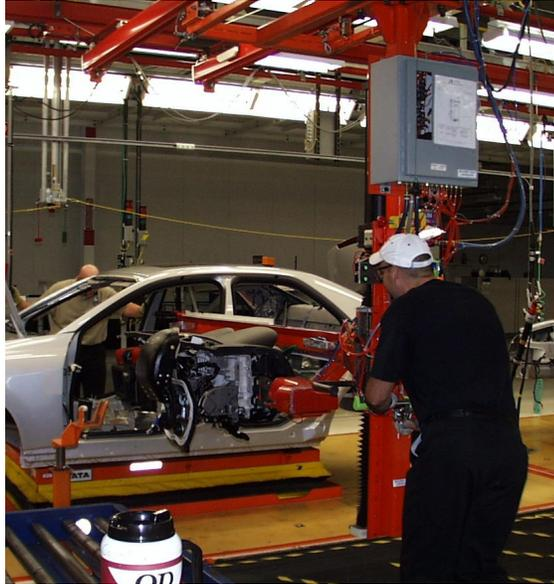
FIG. 7.1 – Exemple d'un robot collaboratif suspendu sur des rails utilisé dans l'industrie automobile (photo gracieuseté de GM Research).
