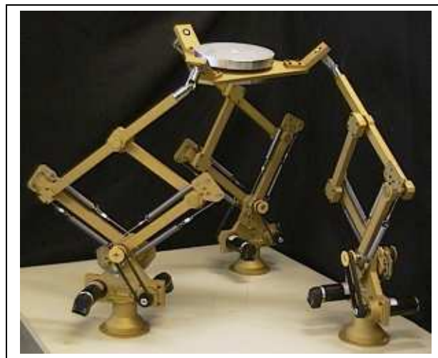
FIG. 1.5 – Manipulateur hybride équilibré statiquement. Courtoisie du Laboratoire de robotique de l'université Laval.
