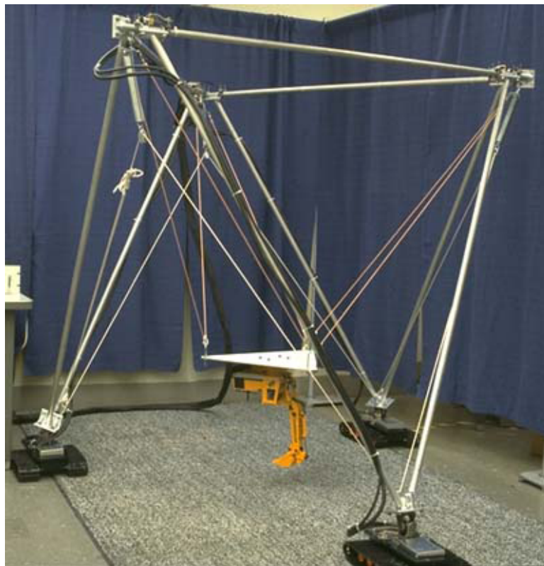
FIG. 1.3 – Une des version du NIST Robocrane, un des premiers robots suspendus entraîné par câble.
