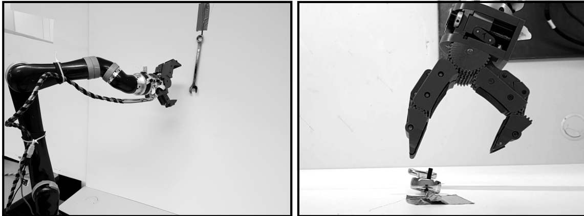
(a) Le préhenseur approche la clef qui repose sur une tige enfoncée dans un mur. (b) Vue du dessus du préhenseur avant le contact avec le mur.
