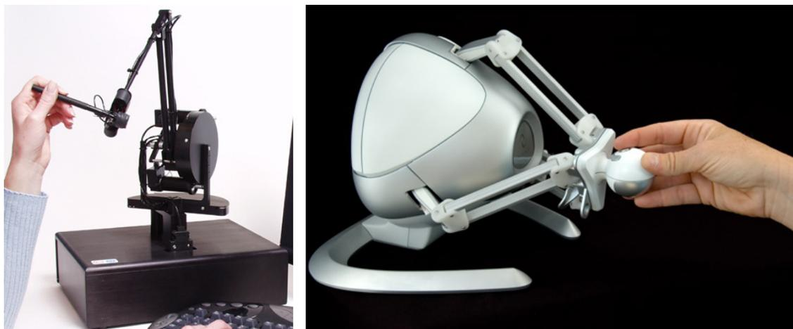
(a) Manipulateur haptique conçu par Phantom. (b) Manipulateur haptique à faible coût Falcon conçu par Novint inc.
