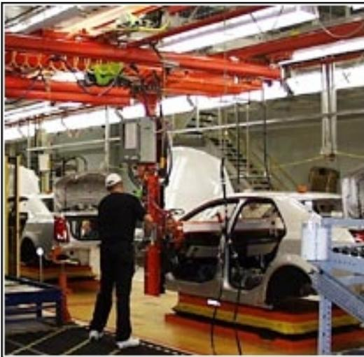
(a) Cobotics™. IAD conçu par Stanley pour assister l'humain dans l'insertion d'un tableau de bord.
