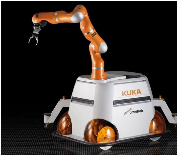
(a) Kuka LWR. Robot d'ipHR (b) Omnirob. Un prototype présenté par Kuka ajoutant une dimension de mobilité au LWR. et maintenant commercialisé par KUKA .
